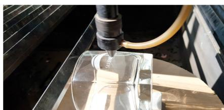
Лазерна порізка та гравірування акрилу, деревини, шкіри, тканини, скла, мармуру, гуми, паперу, металу з покриттям, штучного каменю, двошарового пластику тощо.
